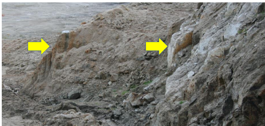
Figura 18 – Observação de oxidação presente no substrato granítico em terrenos na envolvente exterior da Eurocast Portugal Viana
