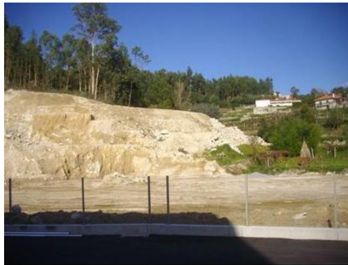
Figura 17 – Observação do maciço rochoso em profundidade com evidência da sua fracturação e alteração
